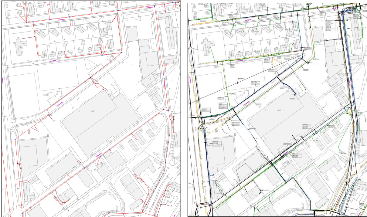
Vasemmalla suunnittelualan kaukolämpöverkosto (punaiset viivat) ja oikealla keski- ja pienjänniteverkon kaapelit (vihreät ja mustat viivat) sekä liikennevaloverkkoa (pinkit viivat) ja ulkovaloverkkoa (keltaiset viivat). (Webmap 2.10.2019)
